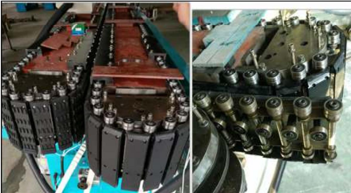
4. La máquina tiene un mecanismo de protección del espesor del vidrio. Cuando se coloca vidrio de grosor incorrecto en la máquina. La máquina se detendrá automáticamente. Esto protege los cojinetes de aplastamiento.
