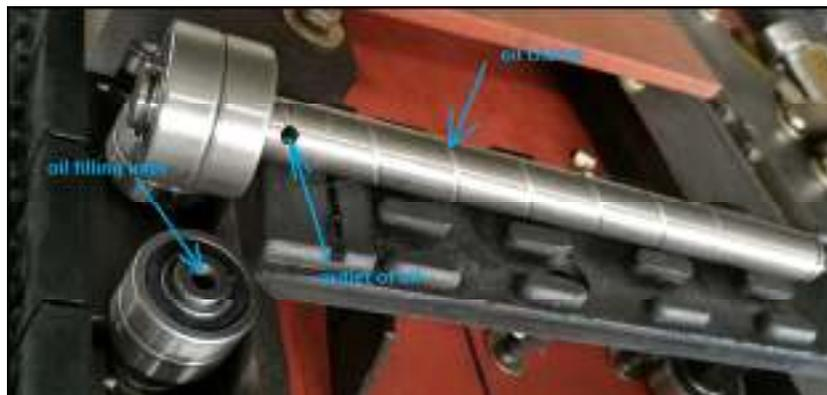
Todas las superficies deslizantes (incluido el movimiento del transportador frontal, la sección móvil de la viga de rectificado, las placas del motor) están lubricadas por un sistema de aceite. El sistema de lubricación de aceite bien diseñado asegura la vida útil de la máquina y un funcionamiento suave durante mucho tiempo.
